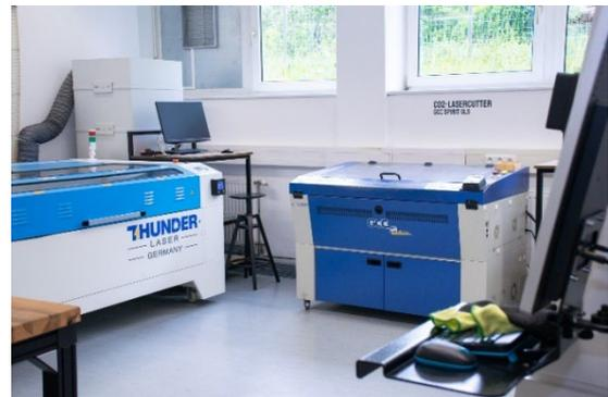
*Drei hoch präzise Laser Cutter schneiden und gravieren Holz, Plexiglas, Stoff und sogar Metall.*
