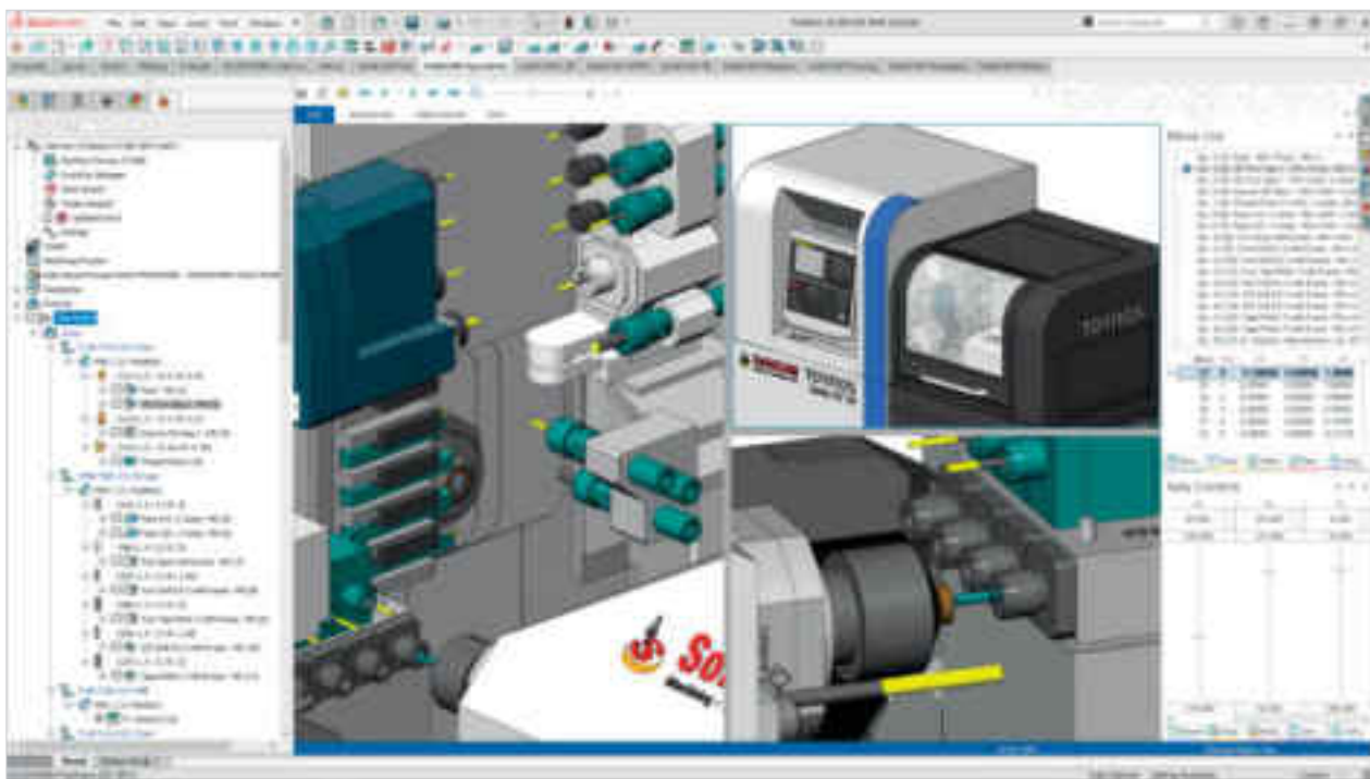
Visuelle Überprüfung und Verifizierung des programmierten Werkzeugweges in der erweiterten Maschinensimulation
