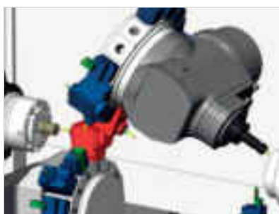
Kollisionsprüfung für Werkstück, Werkzeuge, Halter & Maschinenelemente
