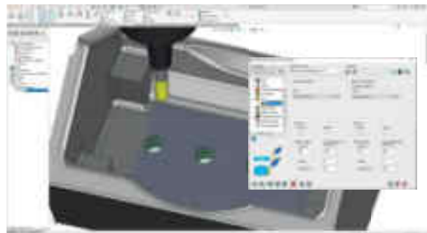
Lineare High-Speed-Schlichtbahnen auf ausgewählter Fläche
