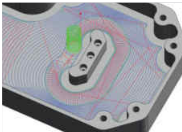
Moating: Intelligente Aufteilung von Flächen zur Maximierung der mit Morphing-Spiralen bearbeitbaren Bereiche
