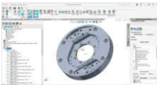
Einzelnes Bohrungsfeature per Drag & Drop-Bohrprozess-Vorlage programmiert
