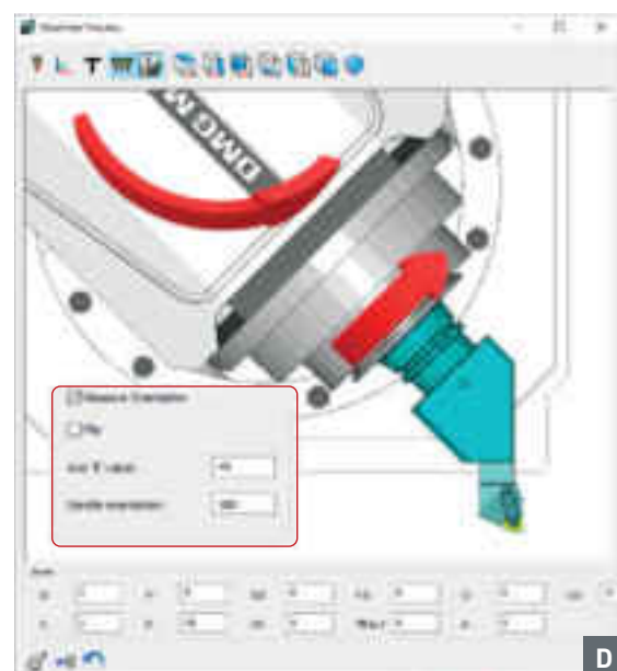
Gemessene Werkzeugausrichtung an schwenkbarer Spindel
