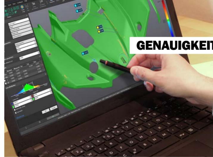
Die HandySCAN 3D | SILVER-Serie liefert präzise und zuverlässige 3D-Messungen, unabhängig von der Qualität der Messeinrichtung und dem Erfahrungsstand des Benutzers. Durch die dynamische Referenzierung können sich sowohl der Scanner als auch das Teil während des Scannens frei bewegen und trotzdem genaue und hochwertige Scans liefern.
