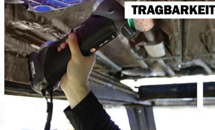
Dieser tragbare 3D-Scanner bestimmt mittels Triangulation von optischen Reflektoren die relative Position des Teils und funktioniert als eigenständiges Gerät, für das kein Stativ oder externes Tracking-Gerät benötigt wird. Er ist kompakt genug, um in einem kleinen Koffer verstaut zu werden, kann überall hin transportiert und unter sämtlichen Umgebungsbedingungen eingesetzt werden, ohne dass hierdurch seine Leistung beeinträchtigt würde.
