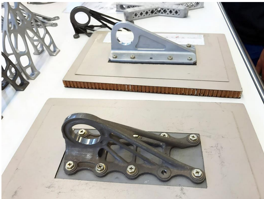
Abb. 118 Kabinenhalter (Bracket) für Airbus A350
