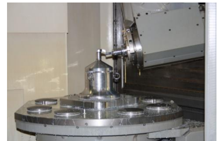
Ohne CAM nicht machbar: das 5-Achs-Fräsen erlaubt die Herstellung komplexer Geometrien.
