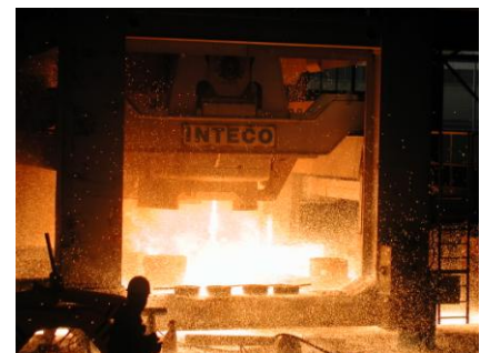
Öffnen des Pfannenschiebers und Angießen für den ersten Block
