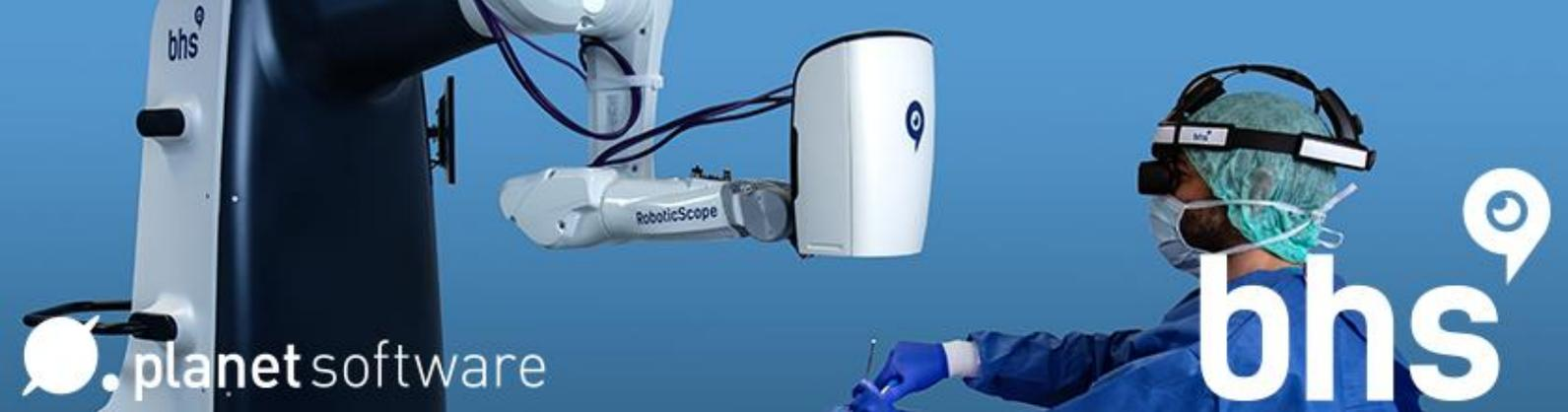
So entstand das RoboticScope® als Kombination aus einer 3D-Mikroskopkamera, die am Ende eines Industrie-Roboterarms montiert ist, und einem selbstentwickelten, sehr leichten Head Mounted Display (HMD). Weniger offensichtlich, aber extrem wichtig ist die digitale Steuerung des Geräts, die es dem Operateur einerseits ermöglicht, durch Drehen des Kopfs andere Blickwinkel einzunehmen und zum anderen darauf achtet, dass der Kameraarm nicht zu nahe an den Patienten fährt oder ins Schwingen kommt.
