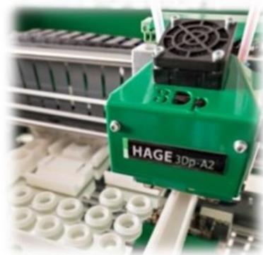
HAGE 3Dp-A2: stabiler 3D Drucker für hochdynamische FDM Rapid Prototyping
