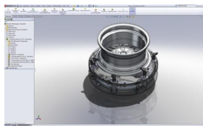
SolidWorks Modell einer Spannvorrichtung für Autofelgen
