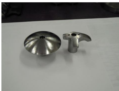
Rohteil und Fertigteil nach 5-Achs-Bearbeitung
