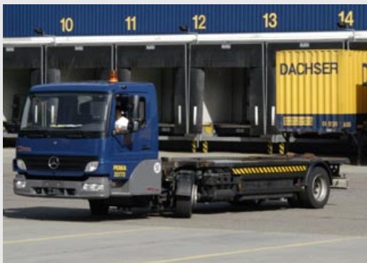
Es geht auch kleiner: der KAMAG TruckWiesel ist eine wendige Zugmaschine für Terminals und Logistikhöfe. Ebenfalls konstruiert in SolidWorks.
