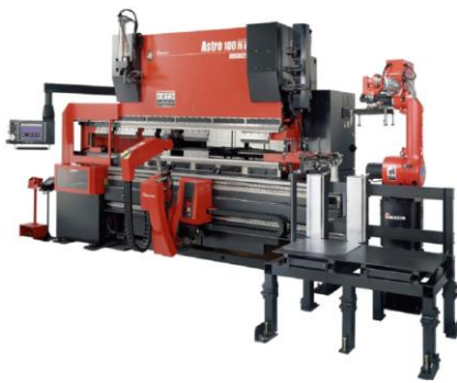
AMADA Anlage mit WKZ-Wechsler konstruiert in SolidWorks
